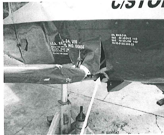
DAÑO EN BASE DEL TREN DE ATERRIJAJE
